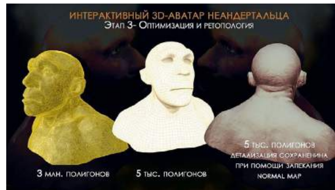
Рис. 4. Ретопология и оптимизация трёхмерного скана при помощи программного обеспечения Instant Meshes. Реконструкция авторов
