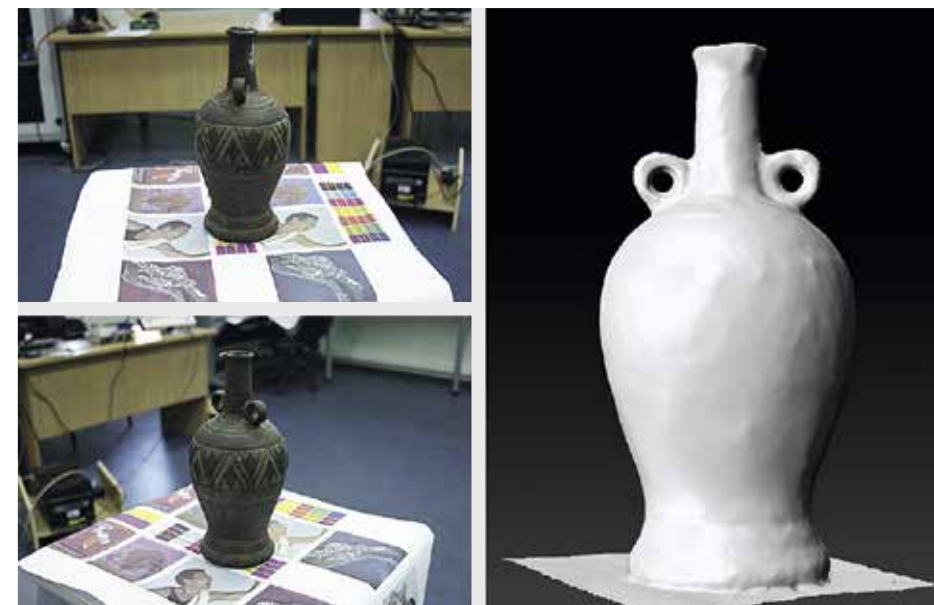
Рис. 8. Процесс создания 3D-модели объекта на основе фотографий
