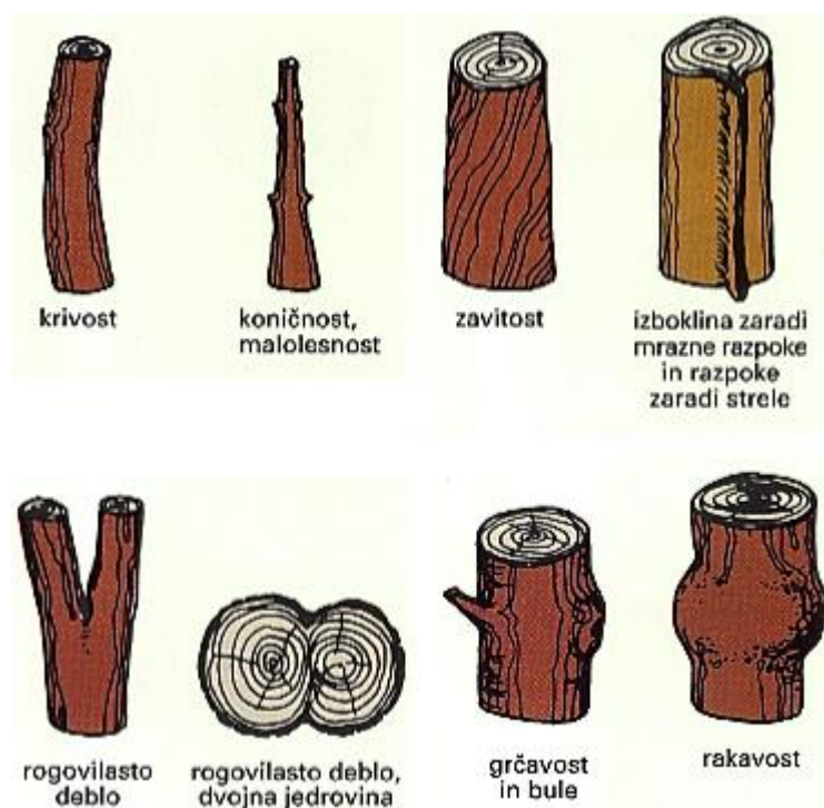
Slika 61: Napake debla (Eckhard, et al., 2008).
