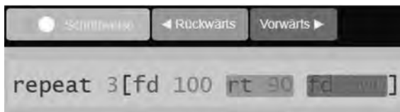
Abb. 14 In Orange der zuletzt ausgeführte und in Blau der nächste auszuführende Befehl
