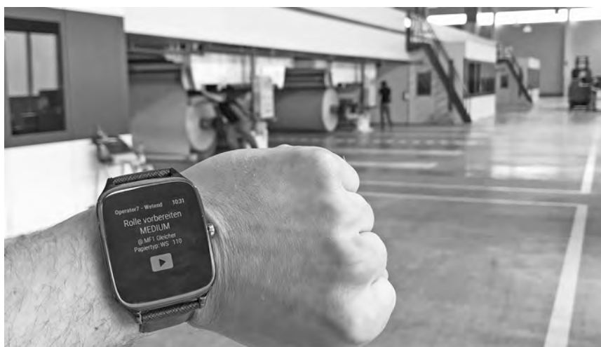
Abb. 5 Mobile Prozesssteuerung auf der Smartwatch
