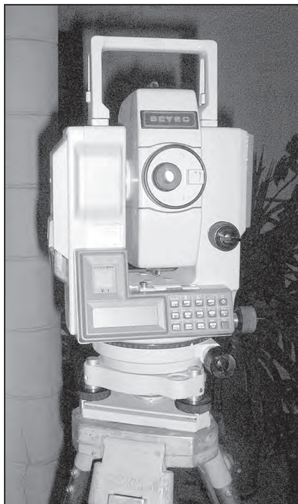
Figure 2: La Total Station utilisée pour la topographie à haute résolution.
